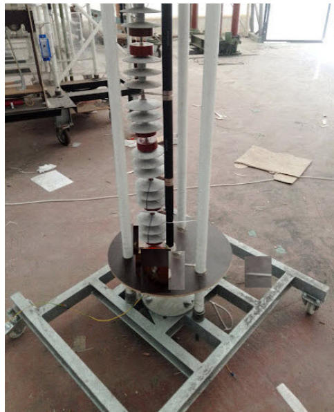
Slika 14.20: Fotografija donjeg dela visokonaponske grane i niskonaponska grana paralelnog mešovitog delila
