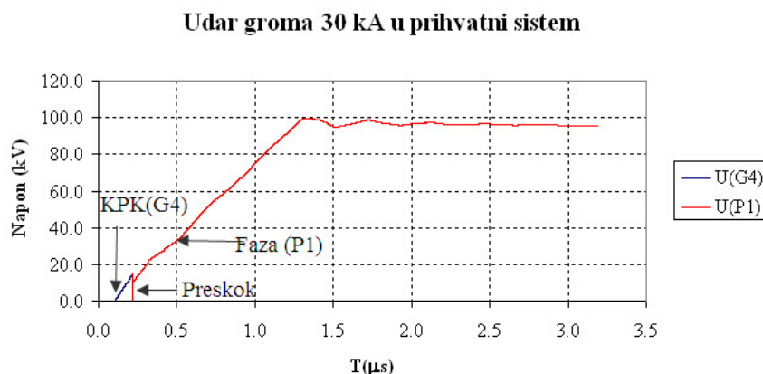
Slika 6.3: Talasni oblik napona na uzemljenom kućištu KPK -kriva U(G4) i na žili kabla -kriva U(P1)
