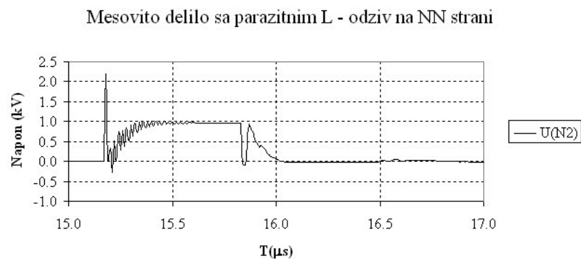
Slika M.19: Rezultati proračuna odziva kada kondenzator C_2 u niskonaponskoj grani ima parazitni induktivitet
