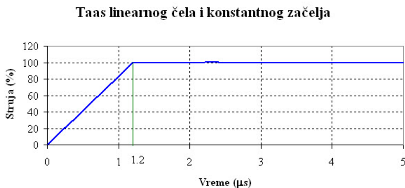
Slika 7.7: Talas linearnog čela i konstantnog začelja
