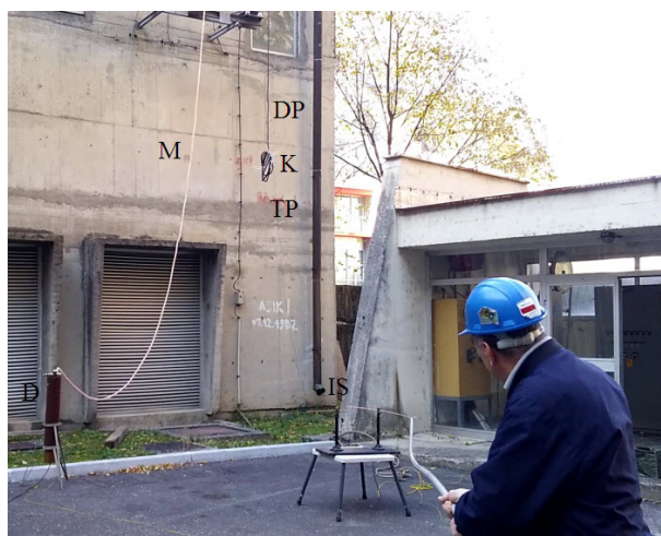
Slika E.4: Fotografija eksperimentalne opreme sa iskrištem za upravljanje električnim lukom
