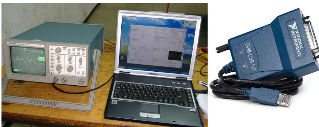
Slika 4.15: Osciloskop i laptop povezani putem GPIB - USB interfejsa (levo) i kabl sa GPIB karticom i USB konektorom (desno)
