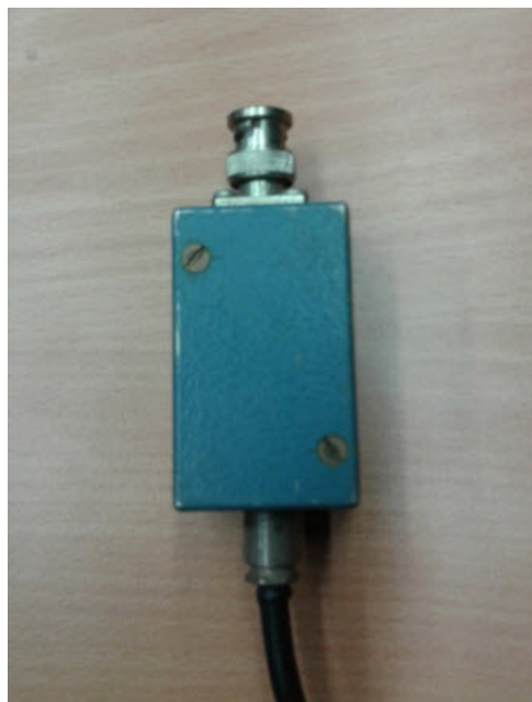
Slika 6.20: Filter za eliminisanje visokofrekvencijskih smetnji
