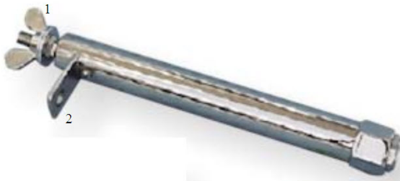
Slika 5.16: Fotografija šanta za merenje velikih udarnih struja
