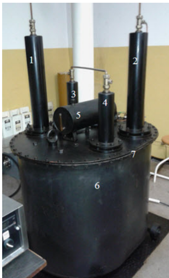
Slika 5.2: Fotografija ispitnog transformatora do 100 kV
