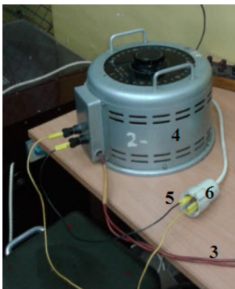
Slika 5.10: Fotografija elemenata za napajanja Teslinog transformatora sa identičnim oznakama kao na slici 5.9
