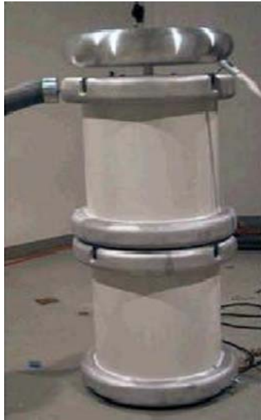
Slika 5.8: Fotografija kaskade od 2 ispitna transformatora napona po 100 kV svaki
