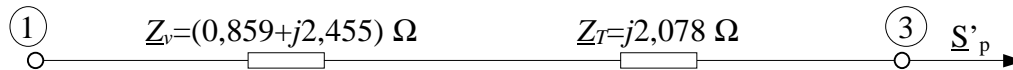
Sl. 1.13d Ekvivalentna šema sistema za nominalni prenosni odnos transformacije regulacionog transformatora
